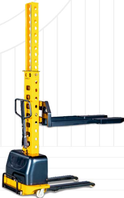
Ein Merkmal dieses Staplermodells ist die Fähigkeit, sich selbst mit Last in den LKW zu laden und dann am Zielort zu entladen. Das Anheben und Absenken der Last sowie das Selbstladen in den LKW und das Selbstentladen erfolgen mit einem Elektrokompessor. Die Steuerung des Auf- und Abstiegs geschieht durch Drücken der Tasten am Gehäuse. Der Stapler wird für die Lieferung sperriger Güter empfohlen, wenn keine Rampen zum Laden in den LKW sowie zum Entladen vorhanden sind.
